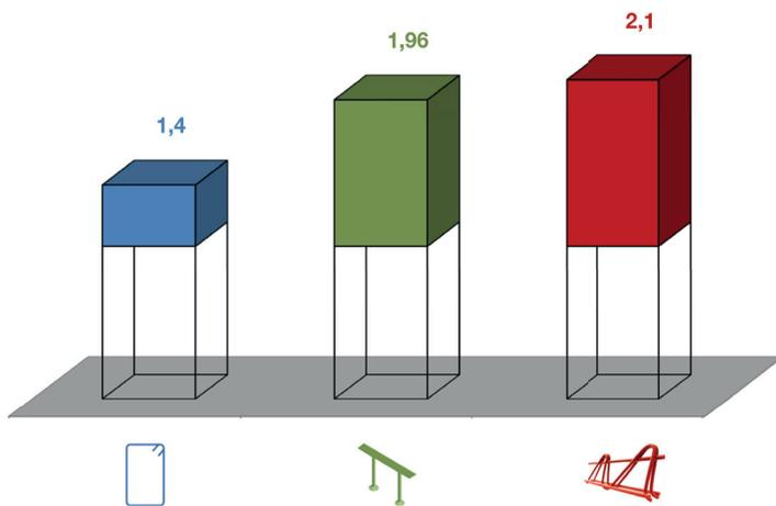
Bild 1. Erhöhungsfaktoren für den Durchstanzwiderstand unterschiedlicher Durchstanzbewehrungen
